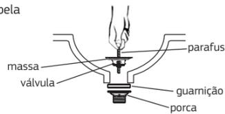
4 Aperte o parafuso, utilizando uma chave de fenda adequada.
