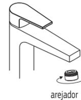
Retire o dispersor da capa metálica e lave ambos em água corrente.
